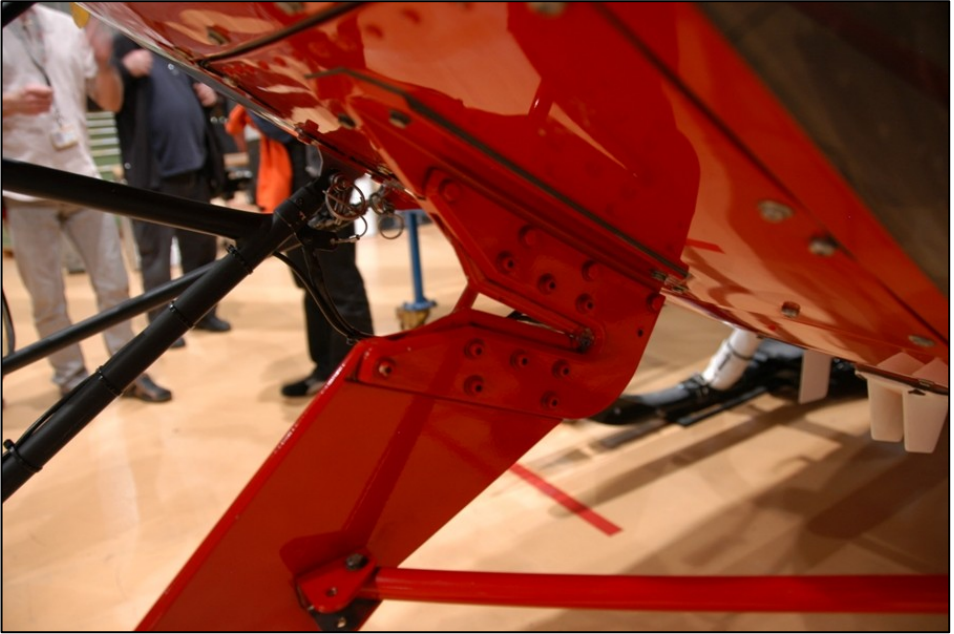
Zwei massive Kabelschneider an der Zelle würden ein unentdecktes Kabel zerreißen...
