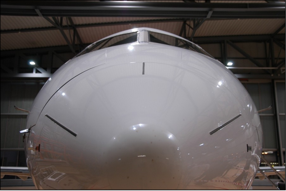
Hinter dem Radom des Rega Jet's „Challenger CL-604“ verbirgt das Wetterradar
