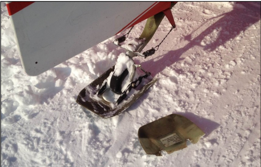
Der noch nicht optimal eingestellte Heckski, „unterschnitt“ im etwas weicheren Schnee und mit schwererem Flugzeug. Dies führte zu einem sofortigen Skibruch.
